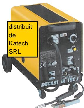
aparat de sudura pe role cu sistem de ventilatie si protectie termica; complet cu pachet flexibil de furtun (2 m), bec de sudare, cablu de masa cu clema puternica, cablu de retea, diuza conica pentru gaz si diuza de curent Ø 0,6 si 0,8 mm;
